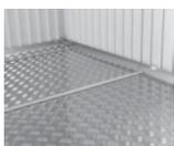
**Plaque de fond** Sol d'aluminium en tôle striée (2 mm) de haute qualité. Le sol se compose, selon la taille de l'abri, de 2 à 4 plaques y compris les glissières d'assemblage. Le cadre de sol est nécessaire à l'installation de la plaque de fond.
