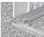
**Cadre de sol** il donne à l'abri Biohort la stabilité nécessaire sur un terrain irrégulier (par ex. pelouse) même en l'absence de fondations. Les ancrages livrés renforcent la résistance à la tempête. Le kit inclut des tuyaux de profil en aluminium (40 x 40 mm) avec quatre équerres en plastique, tout le matériel de fixation et de montage.
