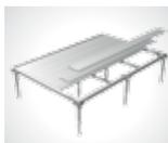
**Fondation à visser** idéale pour corriger l'irrégularité du sol et l'inclinaison de la pente, matériel de fixation et outil pour fixer les vis de terre inclus (outils supplémentaires requis : perceuse à percussion, foret Ø 40 x 600 mm, niveau à bulle, visseuse sans fil, clé de 13 et 24, pelle). Charge max de 200kg/m<sup>2</sup>.
